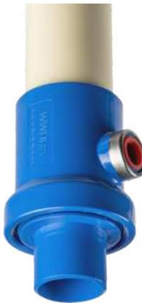
Duschrohr-Wärmetauscher werden senkrecht unter dem Ablauf der Dusche installiert. Durch die **1.700 bis 2.100 mm langen Rohre**, die im Stockwerk unter der Dusche montiert werden, fließt das Grauwasser der Dusche ab und erwärmt im Gegenstromverfahren das in einem äußerem konzentrischen Rohr zufließende Kaltwasser vor.
